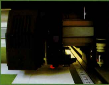
Automatische Passermarkenerkennung bei der FC 4200 Serie erleichtert die Bearbeitung
